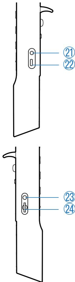
立体声音频接口，可直接连接耳机，或者用音频线连接音箱。详见“连接音箱”（第 23 页）。
